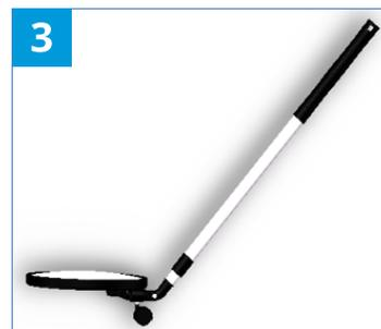
Ослабьте телескопическую рукоятку против часовой стрелки, а затем раскройте телескопическую рукоятку согласно направлению стрелки.
