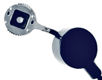
14. Узел ввода кабеля
